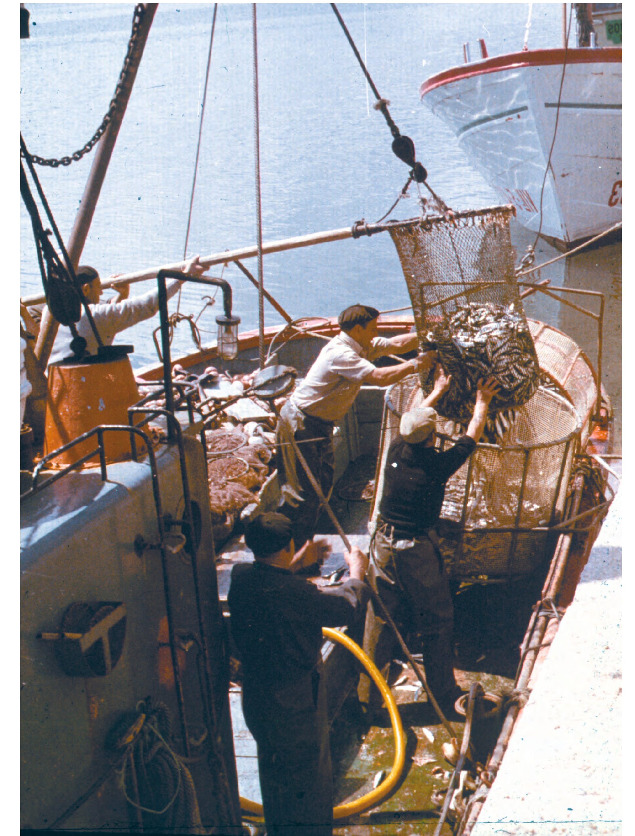
Coa instalación dos haladores e outros aparellos mecánicos a tripulación dos barcos do cerco reduceuse a menos da metade.
