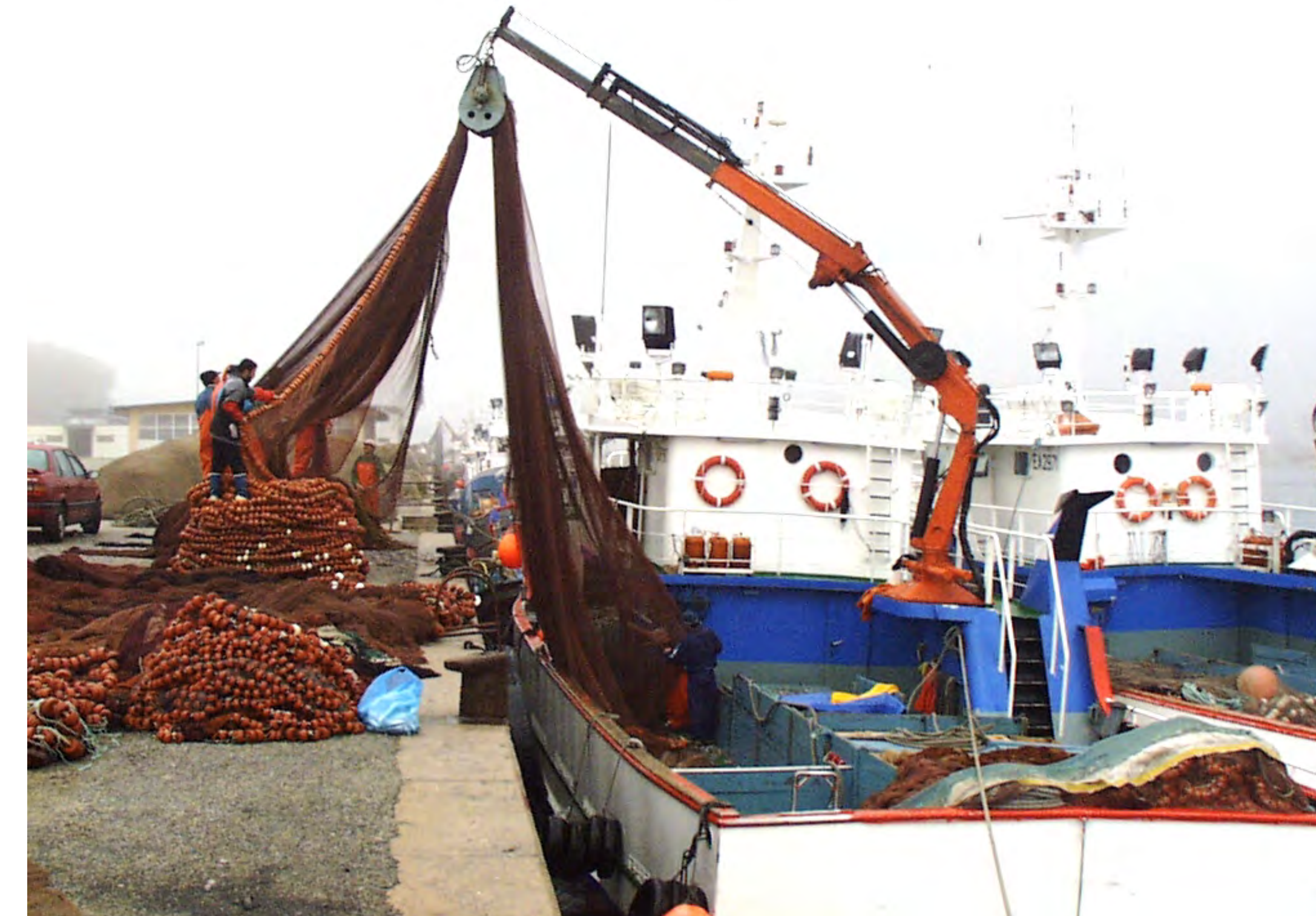
Coa instalación dos haladores e outros aparellos mecánicos a tripulación dos barcos do cerco reduceuse a menos da metade.
